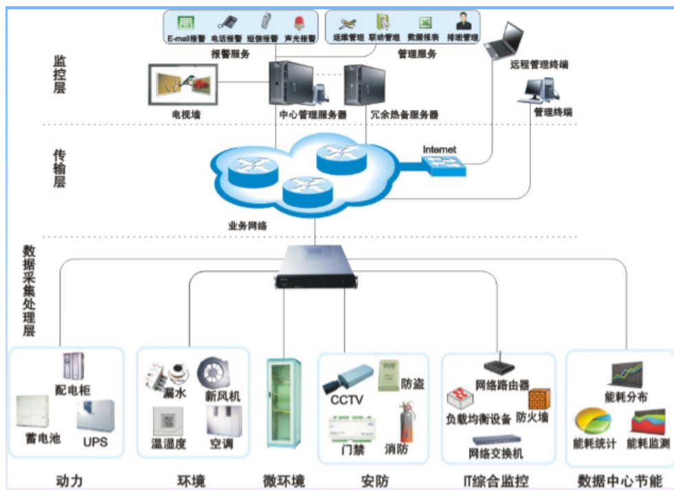
图 4 机房场地监控系统
